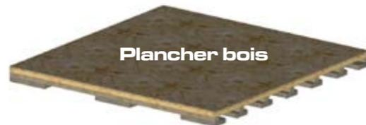
Pose sur terrain naturel. Plancher bois préfabriqué en atelier posé sur chevrons traités et parpaings.
