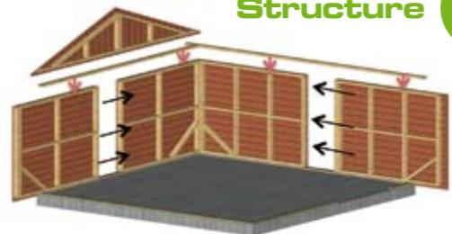
Panneaux préfabriqués en atelier, assemblés sur chantier. Renfort par lisses hautes et sablières.
