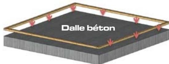
Pose sur dalle béton, avec lisses basses traitées fixées en périphérie.
