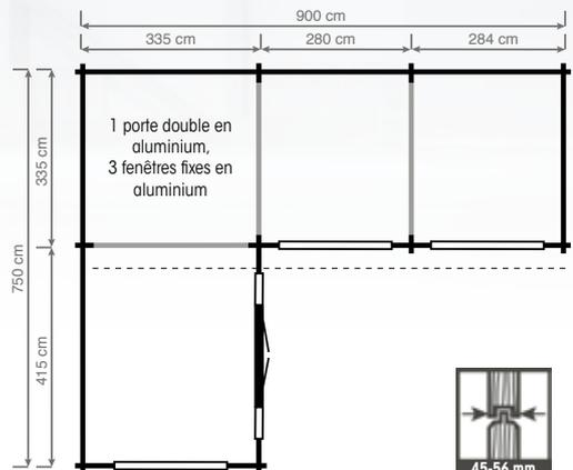
1 porte double en aluminium, 3 fenêtres fixes en aluminium
