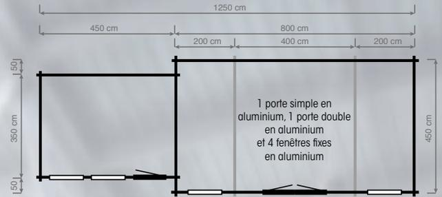
1 porte simple en aluminium, 1 porte double en aluminium et 4 fenêtres fixes en aluminium
