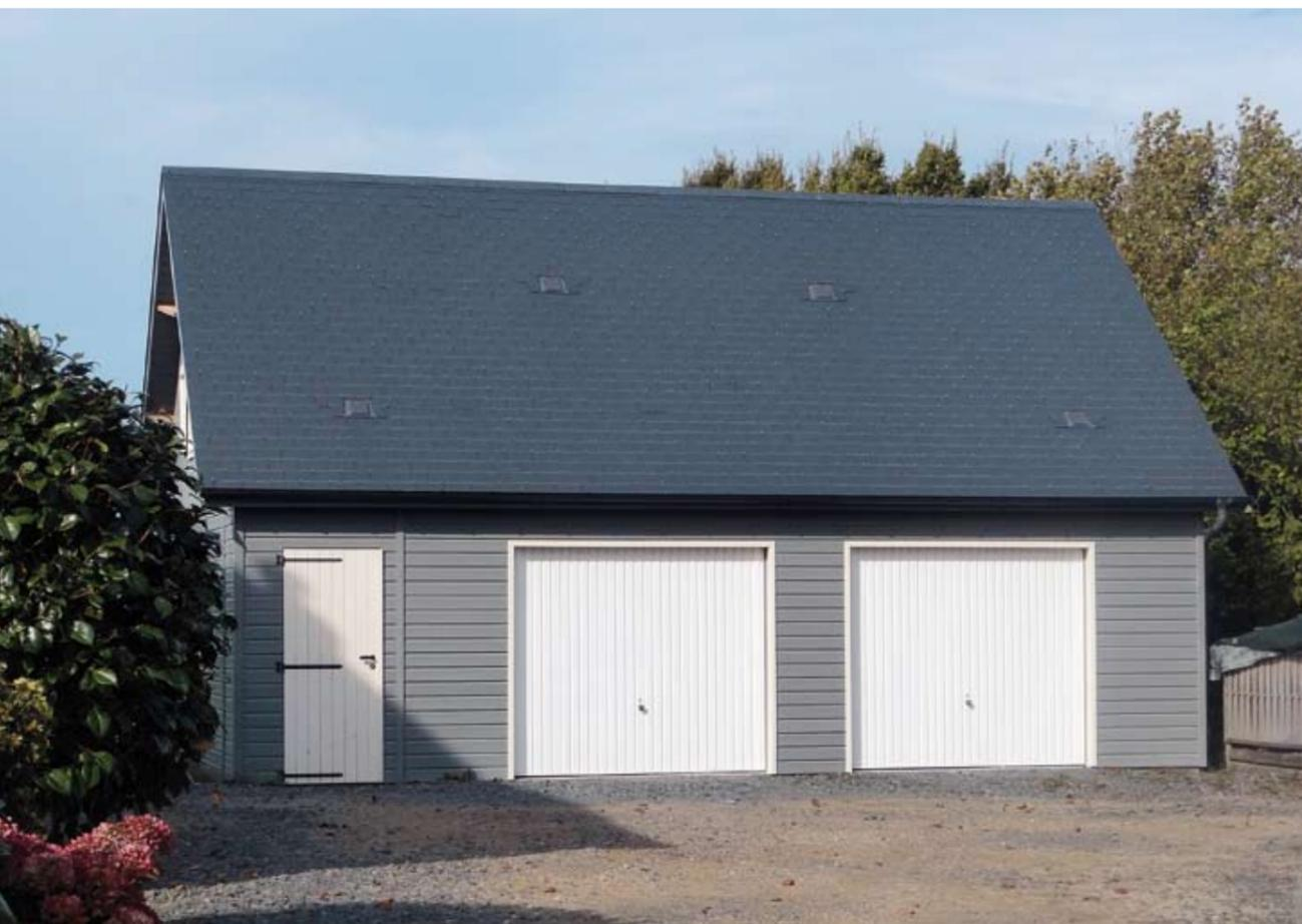
**Modèle 2 pentes** 6,00 x 7,80 m. Bardage en clin couleur gris souris. Portes de garage 2,40 x 2,00 m, basculantes, tablier bardage clin couleur blanc. Couverture en ardoises naturelles. 2 pentes de toiture 45°.
