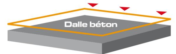
Pose sur dalle béton. Lisse basse traitée fixée en périphérie.
